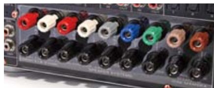
左右声道分为FRONT A与FRONT B，可以分别输出声音信号，也可以选择同时输出
