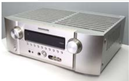
金属材料为铝模压塑而成，同时还有由玻璃纤维强化树脂组成
