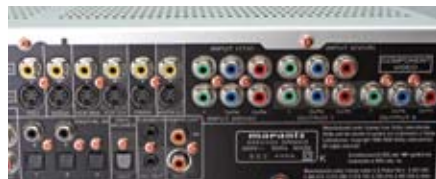
色差端子为3进2出，2组色差可以同时输出影像信号
