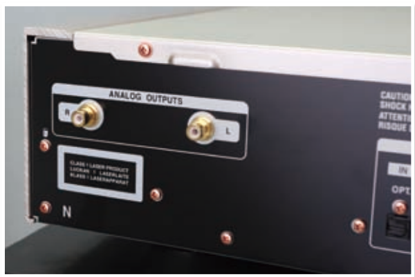
最重要的模拟信号输出端子，使用了颇为发烧的品种
