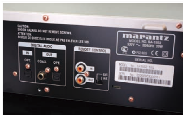
除了光纤数字信号输出端子和同轴数字信号输出端子以连接外置独立解码器外，居然还设有一个光纤数字信号输入端子，使SA-15S2可作解码器之用，可见厂方对其素质具有充分的信心
