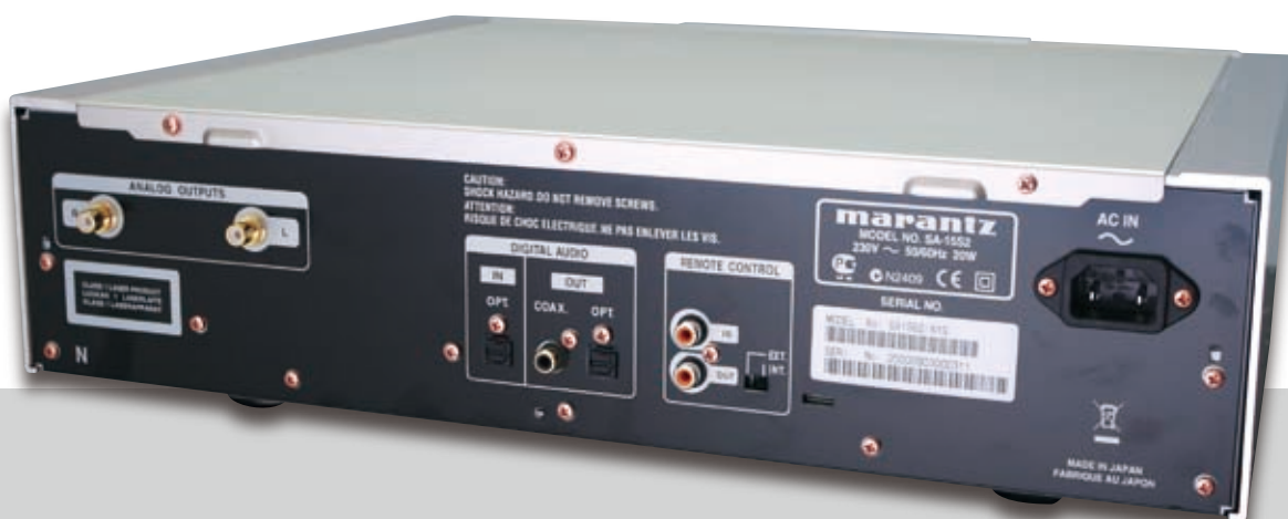
SA-15S2的背部，各种输出输入端子齐备
