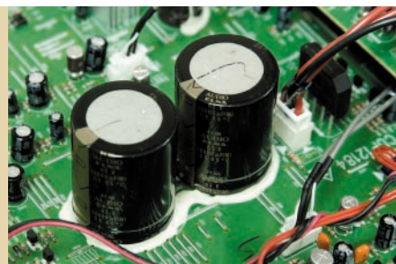
ELNA专用音频电容令该机音效水平得到提升。
