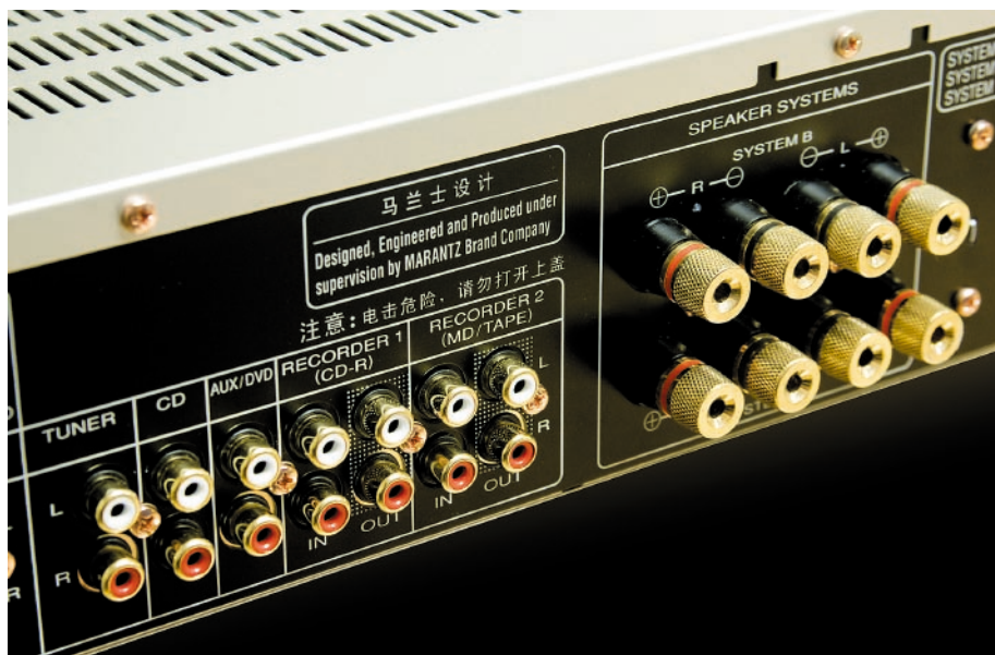
PM6003的后背板布置规整、端口齐全。
